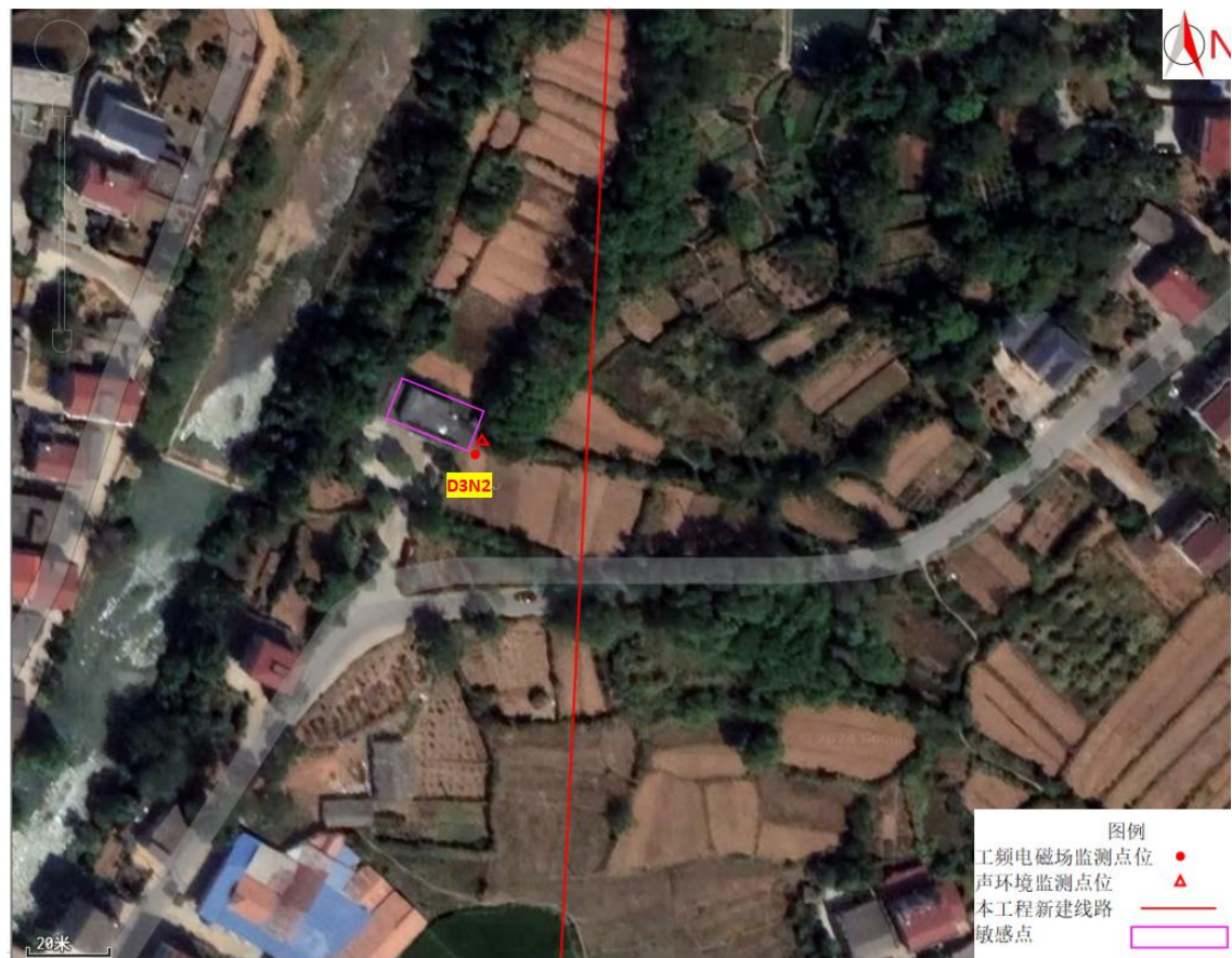
图 7.4 本项目工频电磁场监测布点示意图
