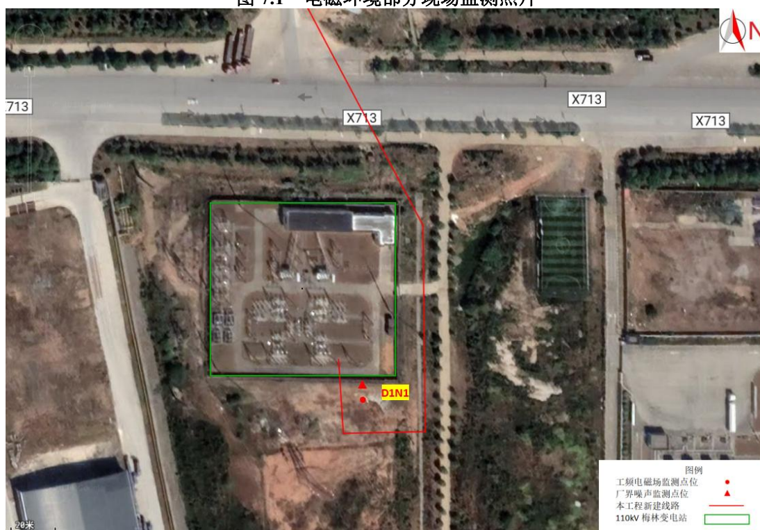
图 7.2 本项目工频电磁场监测布点示意图
