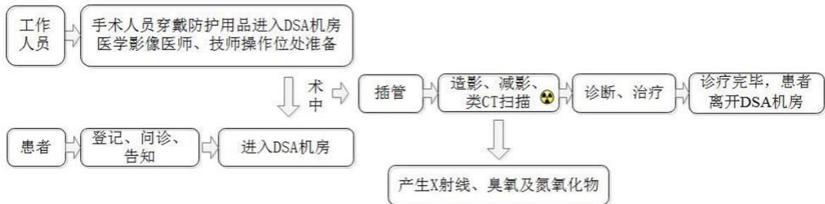
图 9-2 DSA 诊疗流程及产污环节示意图
